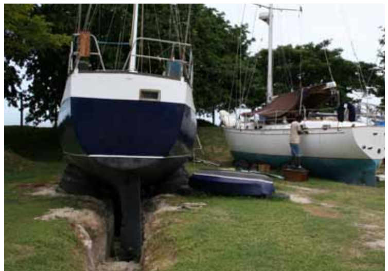
Eingegrabene Schiffe im Hurricane Hole Vuda Pt. Marina
